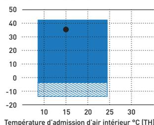
En mode chauffage. Température d'admission d'air extérieur °C (TH)
